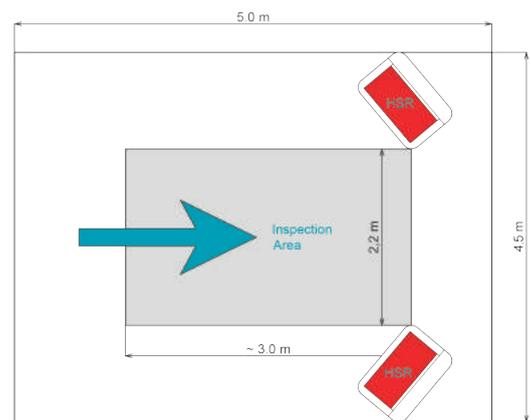
HSR®インストールのスキーム。矢印は人の流れの方向を示している。アラームモニタは、近くに、または遠い場所に設置が可能。
